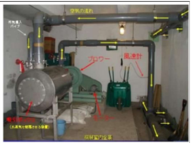
発酵槽に空気を送り、好気性発酵させます
